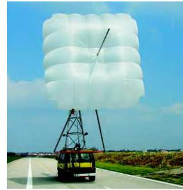
Nur der Widerstand zählt. Messung der Sinkgeschwindigkeit am Flugmechanik-Messwagen wird.
